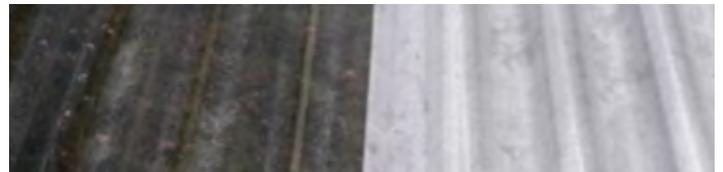
Température du Globe Noir (TGN) en degrés à l'abri du vent en-dessous d'une tôle éclairante repeinte de l'intérieur ou brute (non repeinte)
